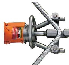
アンカー曲げ
